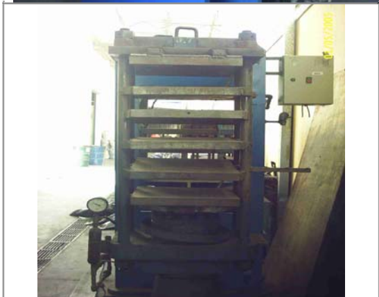
PRENSA VARÃO Plator 500mm x 500mm x 5 vãos Pistão 200mm - 10 cv Valor.: $ 12.000,00
