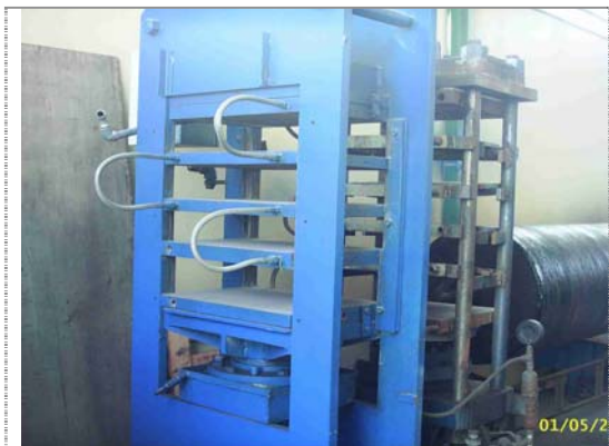
PRENSA CHAPA 1" Plator 40mm x 60mm 4 vãos Pistão 200mm - 10 cv Valor.: $ 15.000,00
